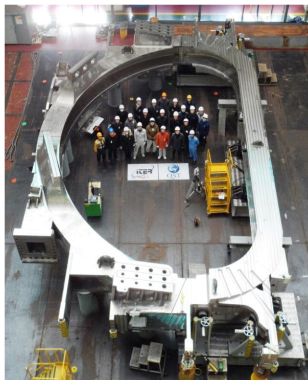
図 4. 製作を完了したコイル容器第 1 号機
