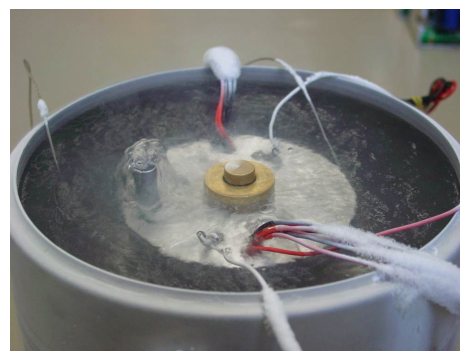
図 浮上型超電導モータのポンプ応用実験
