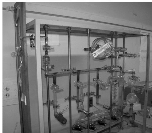
写真1 この20年間、毎日活躍している多機能ガラス封じ切り装置。水銀系銅酸化物超伝導体、MgB 2 、鉄系超伝導体などの合成における石英管真空封入だけでなく、任意の雰囲気ガスとともに石英管に試料を封入することができ、アニール、急冷後には均一な酸素組成を持つ酸化物試料が得られます。
