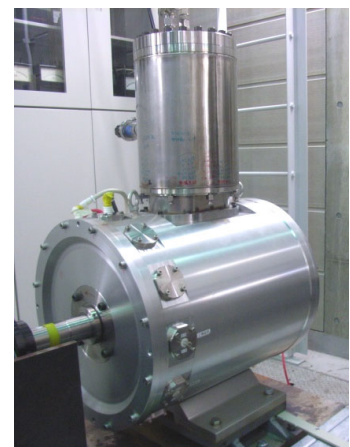
図3：20 kW級高温超伝導誘導同期回転機 (HTS-ISM) プロトタイプ機
